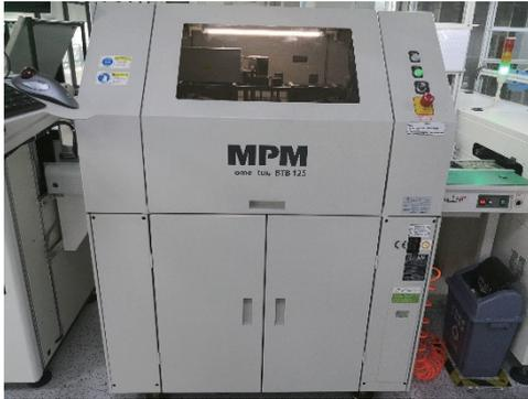
錫膏本質上是用於印刷電路板並浮於強力助焊劑的粉狀金屬膏。自動印刷機在組裝前會將錫膏印刷在印刷電路板上。有時，根據客戶的要求或產品規格，我們會透過自動光學檢測及／或目測確認錫膏是否有成功印刷。該步驟至關重要，其確保我們僅於正確的印刷電路板部位塗上錫膏及組裝元件在印刷電路板組裝後有足夠的錫膏順利進行焊接。
