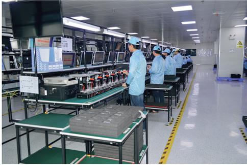
我們會人工或使用自動化測試機器測試印刷電路板組裝的整體質量，確保其符合本集團及客戶的要求標準，方法為對所有在製品進行檢測、即時進行缺陷分析及及時進行維修分析。製成品的測試包括進行目測及對印刷電路板組裝進行測試、模擬印刷電路板組裝的正常運作環境，以檢查印刷電路板組裝的功能性及與設計的一致性。
